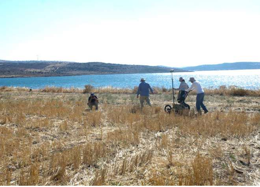
Fig. 80 Gryneion Antik Kenti 8 No.lu bölgeye ait GPR radar ölçüm fotoğrafı, Aliğa/İzmir.
