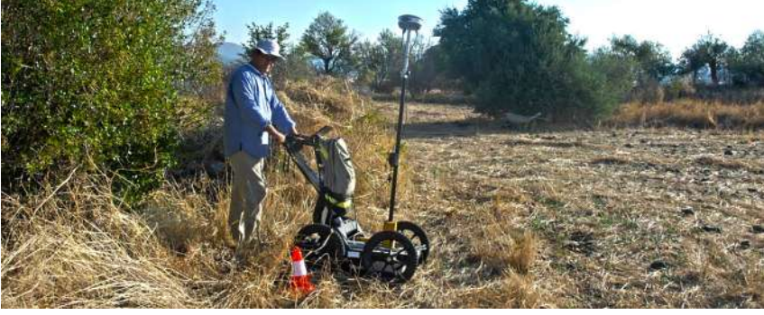
Fig. 38 Gryneion Antik Kenti 2 No.lu bölgeye ait GPR radar ölçüm fotoğrafı, Aliğa/İzmir.
