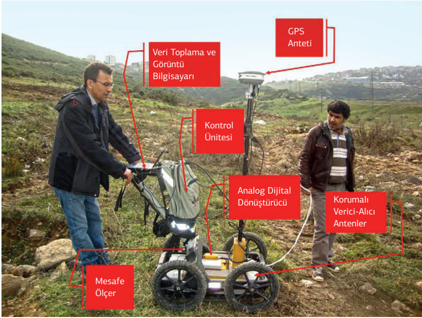
Fig. 21 Yer radarı ve ekipmanları.
